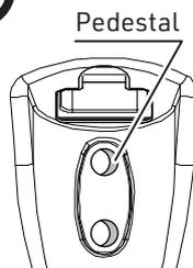
Ao girar o aparelho, deve ser possível abrir ou fechar o acesso aos furos do parafuso. (Os furos ficam acessíveis quando o aparelho está alinhado com o pedestal)
