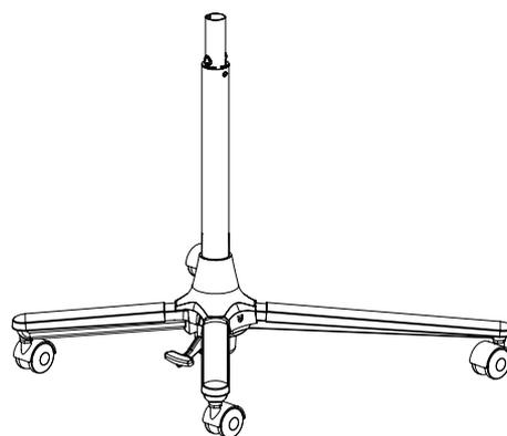
Após apertar os parafusos, encaixe a base pesada novamente.
