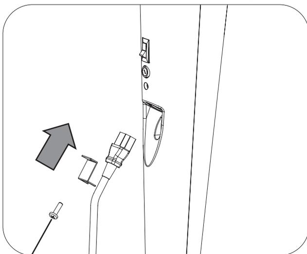
1 parafuso cabeça panela M3 x 15
