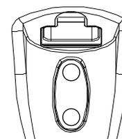
Ao girar o aparelho, o acesso aos furos do parafuso ficam permanentemente abertos.
