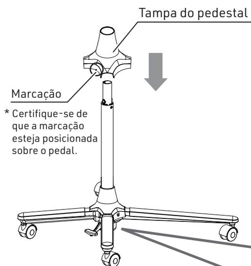
\* Como na figura abaixo, coloque a tampa do pedestal de modo que os ganchos encaixem no pedestal.
