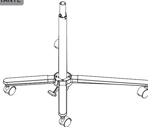
Certifique-se de que o diâmetro dos parafusos não esteja obstruindo o ajuste da coluna em relação ao pedestal.
