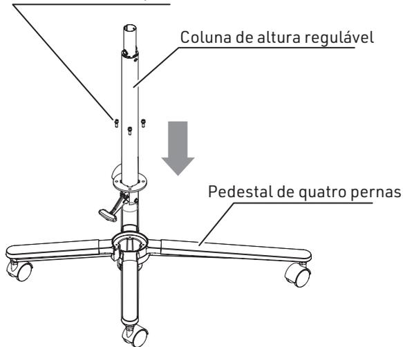
Encaixe a coluna de altura regulável no pedestal.
